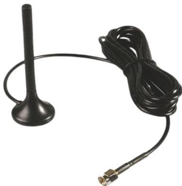
L'antenne ANT-868STD convient pour une utilisation avec une centrale Power-Elec configurée en LoRa. Ses caractéristiques permettent une utilisation dans des environnements dégagés ou sans parois épaisses (locaux tertiaires en RDC ou étage, entrepôts logistiques...). Son embase magnétique simplifie l'installation sur les armoires électriques tout en se servant de cette enveloppe pour améliorer sa sensibilité.
